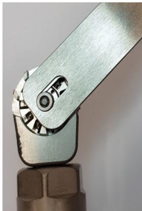
**1** Spanschlüssel an der Spannzanze ansetzen.
