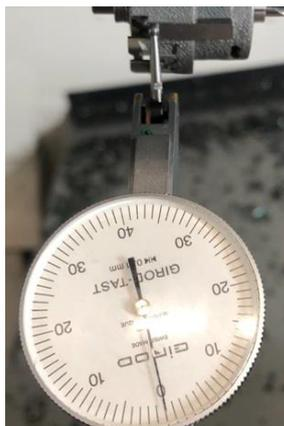
**4** Verwenden Sie eine Messuhr, um das Spindelgehäuse an der Ausrichtungsfläche auszurichten.
