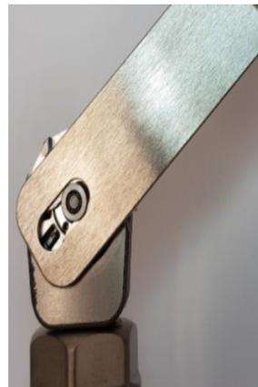
**2** Spanschlüssel gemäß dem Bild in Position bringen. Anschließend die Spannzanze durch Drehen lösen.
