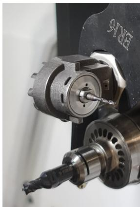
**5** Anziehen der ER16-Mutter im Werkzeughalter mittels ER16-Spanschlüssel.
